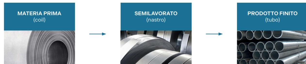
La produzione dei tubi saldati longitudinalmente segue specifiche fasi, di cui si riportano le principali; per quanto simili, presentano diverse tipologie di acciaio:
